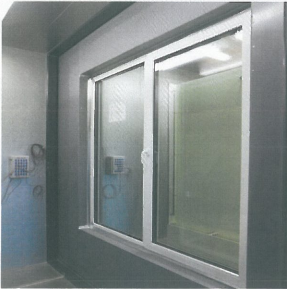
<사진 1> 열관류율 항온측 시험체 모습
