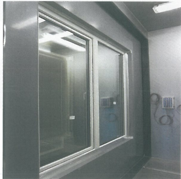
<사진 2> 열관류율 저온측 시험체 모습
